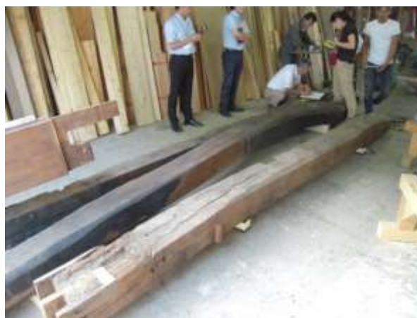
写真 20 非破壊検査による強度測定（2）
