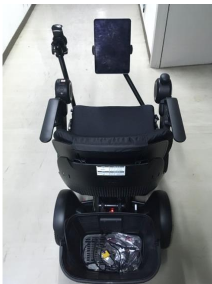
図 1 開発したパーソナルモビリティ (WHILL Model CR 及び iPad Pro で構成)
