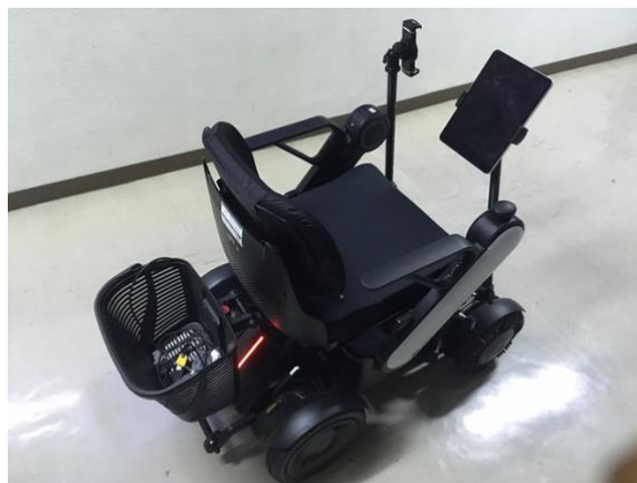
図 1 開発したパーソナルモビリティ (WHILL Model CR 及び iPad Pro で構成)
