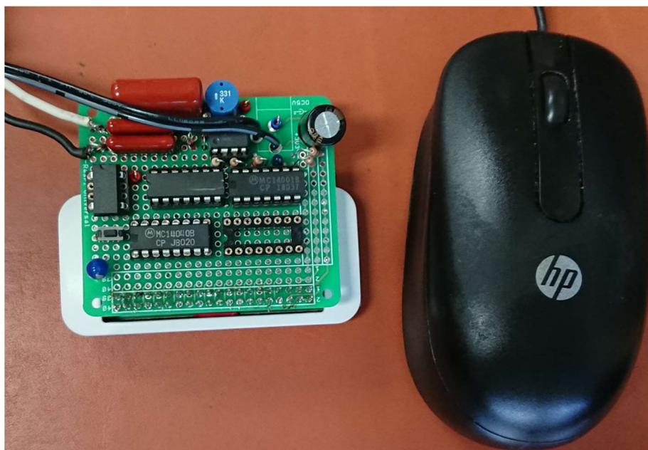
写真 1. 電源周波数測定用 IoT センサーノードの実装
